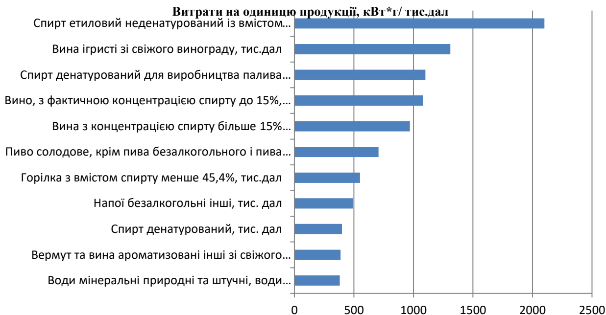
Рис. 2. Використання електроенергії підприємства на одиницю виробництва рідинної продукції, кВт*г/тис.дал
