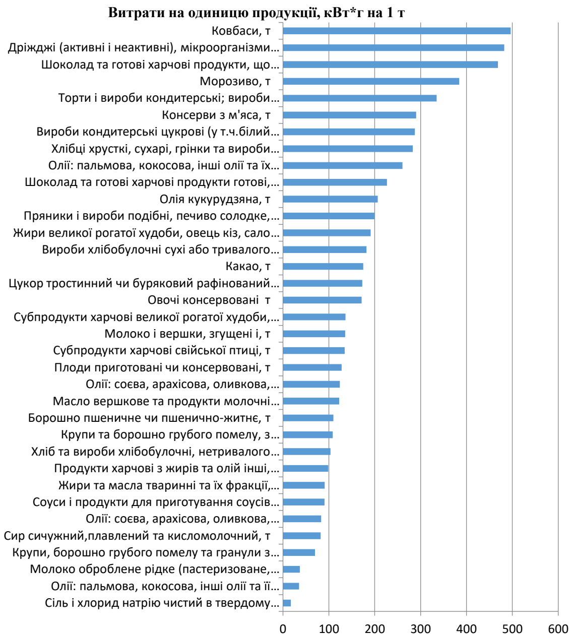
Рис. 1. Використання електроенергії підприємства на одиницю виробництва продукції, кВт*г/т (Джерело: систематизовано за даними Державної служби статистики).
