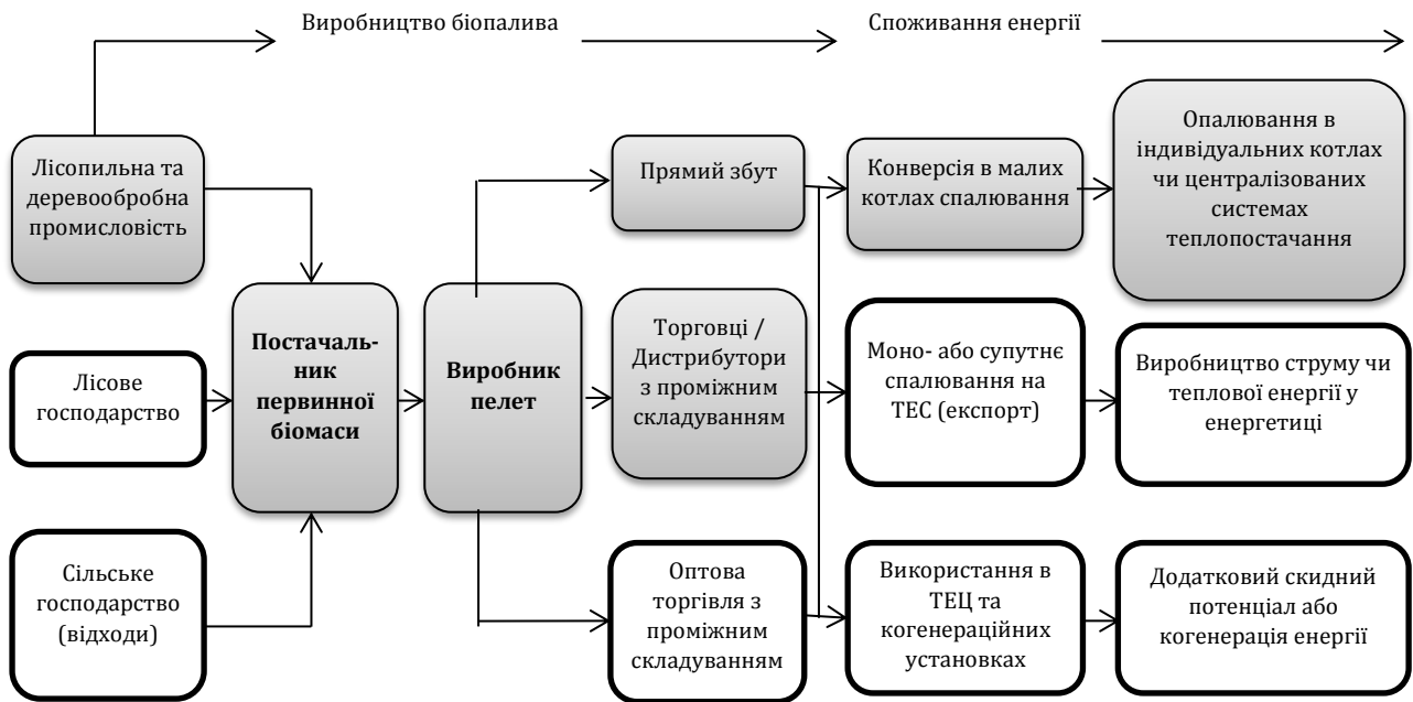
Рис. 1. Процесний ланцюжок виробництва, збуту та енергетичного використання пелет 1
